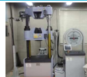
万能油圧試験機による材料物性の調査
