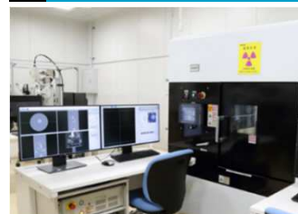
マイクロフォーカスX線CT装置による内部構造の三次元観察
