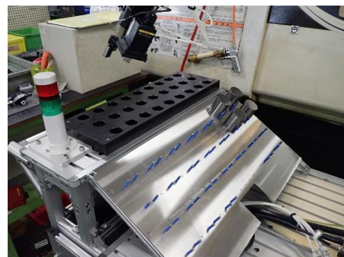
夜間無人化を実現した周辺設備
