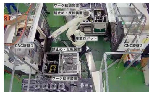
ロボット1台でCNC旋盤加工機2台のオペレーションを実現
