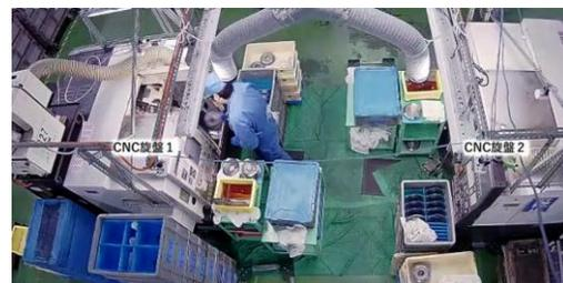
人手で行っていた旋盤加工機2台持ち作業
