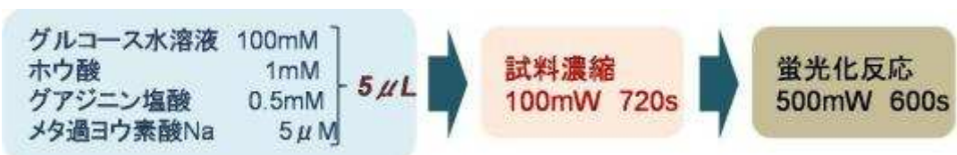
図2 デバイス評価におけるグルコース定量実験手順
