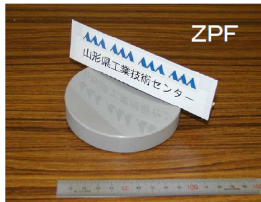
ZPFの加工例 表面粗さ Ra 3.8nm 形状精度 400nm(評価長100mm)
