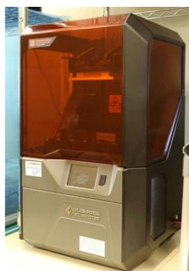
図3. 光造形方式3Dプリンタ (Hunter)
