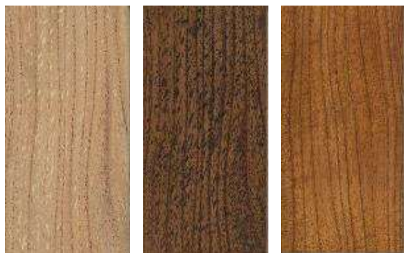
図 7 センダン無塗装材: 左, センダン塗装材 (素地着色前処理無し): 中央, センダン塗装材 (素地着色前木質強化剤処理有り) 右の各画像
