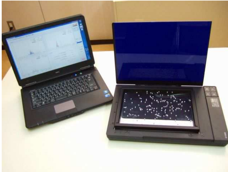
図2 パソコンとイメージスキャナだけで構成されたプラスチックペレット検査システム
