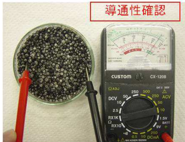
図1 CNTを添加した発泡スチロール
