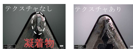
図 5 チップブレイカー内の耐凝着評価
