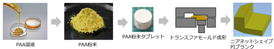
図 1 従来技術による PI 成形体製造方法
