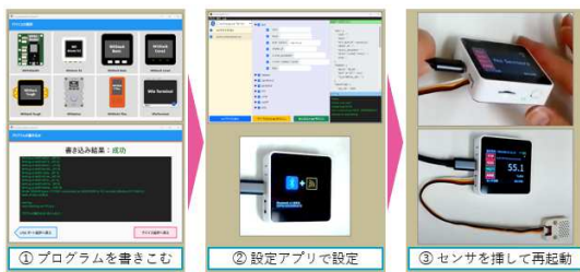
図 6 エッジデバイスへの書込・調整
