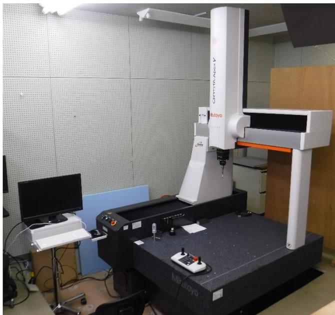
直交するX/Y/Z軸の任意の位置に移動し、測定子が接触したときの座標をデータ処理することで、三次元形状部品の寸法、位置、角度、幾何公差などを精度よく測定できます。また、CADデータを用いた設計照合や測定プログラムの作成が可能です。
