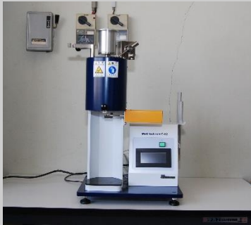
メルトインデクサー (株) 東洋精機製作所 G-02 型
