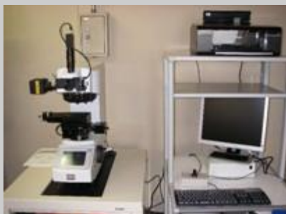
マイクロビッカース硬度計 (株) ミットヨ HM-221 オートフォーカスユニット
