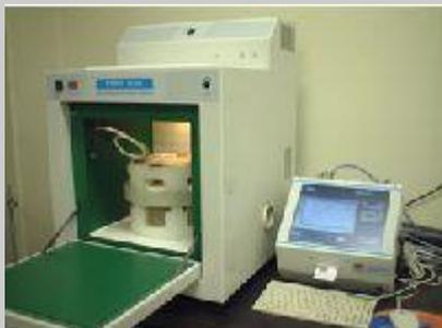
マイクロウェーブ試料分解装置
