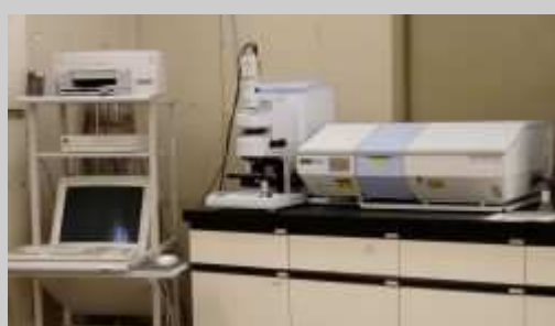
フーリエ変換赤外顕微分光光度計 (株)パーキンエルマー Spectrum BX/MultiScope(ATR)型
