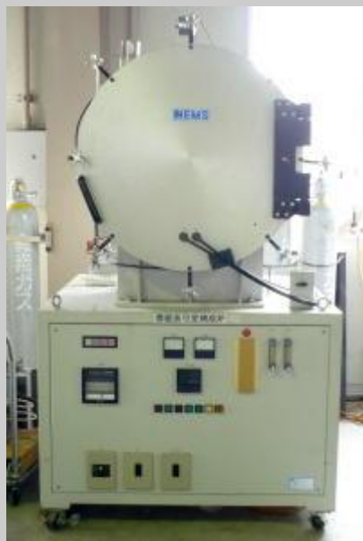
雰囲気可変焼成炉 ネムス（株） SCO-1800IS
