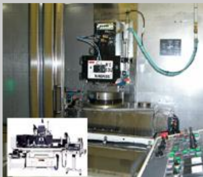
超精密非球面研削盤 (超精密加工機) (株)ナガセインテグレックス N2C-53US4N4
