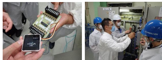
開発したIoT機器と制御盤への取り付け
