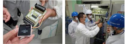
開発した IoT 機器と制御盤への取り付け
