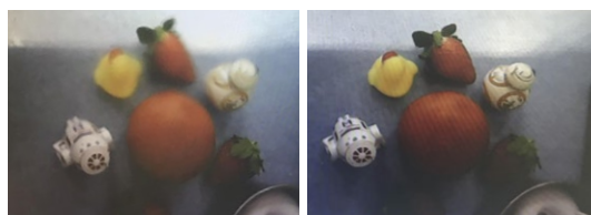
図2 レンズカバー試作品を通した画像比較 (左：親水処理なし、右：親水処理あり(開発品))
