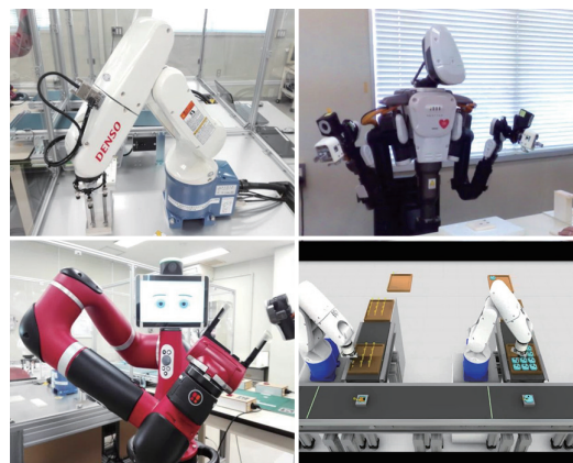
お試しいただけるロボット群（左上：垂直多関節ロボット VP-6242、右上：双腕ロボット NEXTAGE、左下：協働型ロボット Sawyer、右下：生産シミュレーションシステム 3D Automate）
