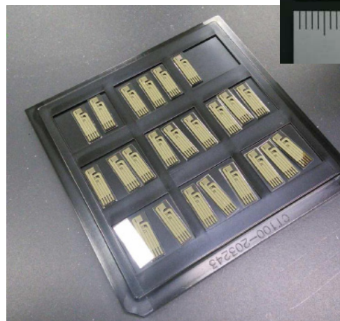
搭載された MEMS センサ
