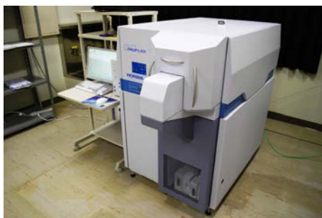
図1 グロー放電発光分光分析装置
