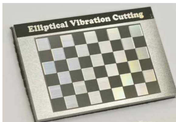
図2 ダイヤモンドコーティング工具による格子模様加工例 (材質:Stavax 40 × 60mm, 硬度:54HRC) 知の拠点あいち重点研究プロジェクト成果品
