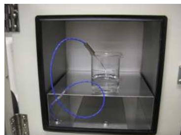
庫内 (シースセンサーによる温度測定)
