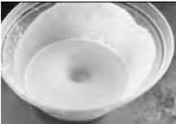
図 5 通常条件に K_2CO_3 と HCl を添加 （スラリー状）
