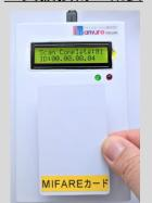
センサーネットワーク技術を利用し、RFIDリーダーの無線通信ネットワークを構築しています。 導入後も自社内でメンテナンスや改良などの運用ができるように、極力、汎用デバイスやソフトウェアを利用した使いやすいシステムで設計しました。
