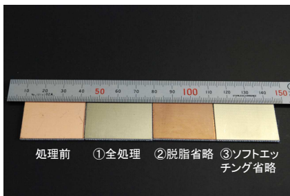
図 1 電子基板用表面処理 (NiP めっき／銅張積層基板)
