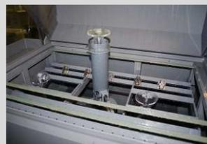
ステンレス鋳鋼は、ステンレス鍛錬材に比べて耐食性が劣ることがあります。耐食性劣化の原因を調査し、熱処理技術やその前処理条件を確立することによって、中性塩水噴霧試験(48時間)において、鍛錬材と同等の耐食性を得ることができました。
