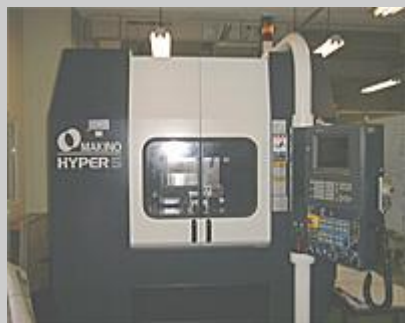
ATC 付 NC 立型ミーリングマシン (株)牧野フライス製作所 HYPER5
