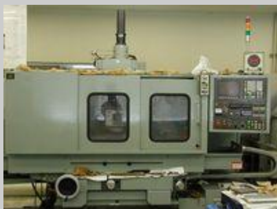
超精密成形平面研削盤 (超精密加工機) (株)ナガセインテグレックス SGU-52HP2
