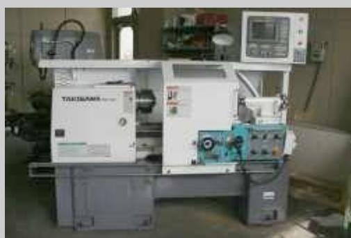
2 軸制御 NC 旋盤 (株)滝澤鉄工所 TAC-360 型
