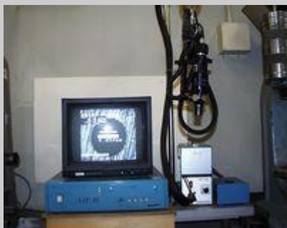
ブリネル硬度計圧痕読取装置 (株)ロゼフテクノロジー LHB-5T
