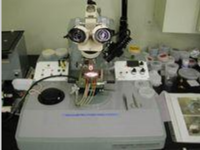
ワイヤボンダ 超音波工業（株） USW-5Z60K
