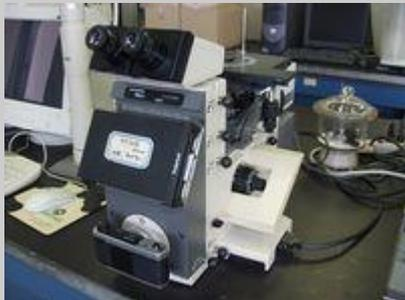
倒立型金属顕微鏡
