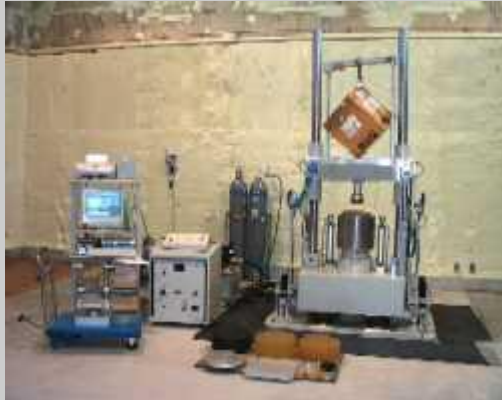
落下衝撃試験装置 神栄テクノロジー (旧 吉田精機) ASQ-700
