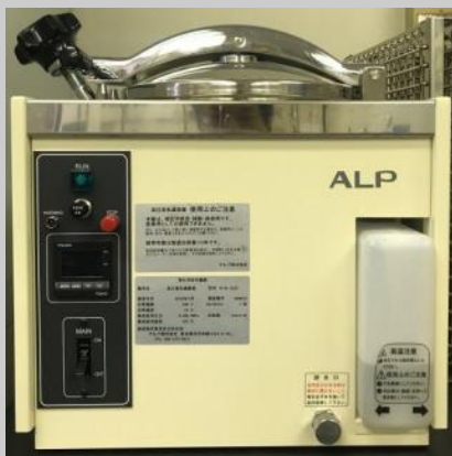
オートクレーブ（抗菌性試験機器） アルプ(株)製 理化学用オートクレーブ KTR-2322 型
