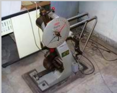
衝撃試験機（シャルピー） （株）東京衝機製作所 CIEM-5-D
