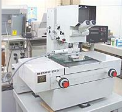
万能測定顕微鏡 カールツァイス ZKM01-250D
