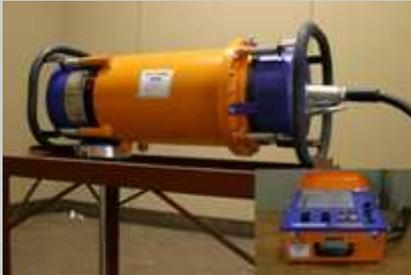
工業用 X 線検査装置
