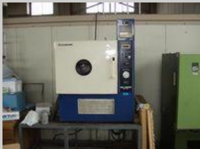
サブゼロ処理装置 タバイエスペック MC-81
