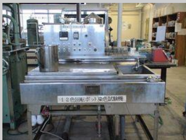
12色回転ポット染色試験機 テクサム技研 MC-12N
