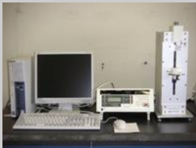
食品用圧縮試験装置 (クリープメータ) (株)山電 RE2-33005B
