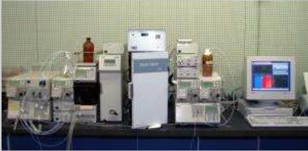
高速液体クロマトグラフ 日本分光(株) GULLIVER HPLC システム
