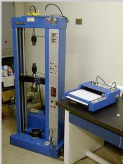
環境可変型材料試験機 東洋ポールドウィン（株） テンシロン UTM-4-100
