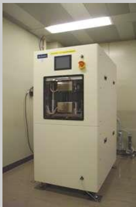
環境型微細プレス加工装置 (熱ナノインプリント装置) SCIVAX (株) X-300
