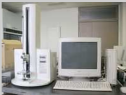
食品テクスチャーアナライザー (株)島津製作所 EZTest 型
