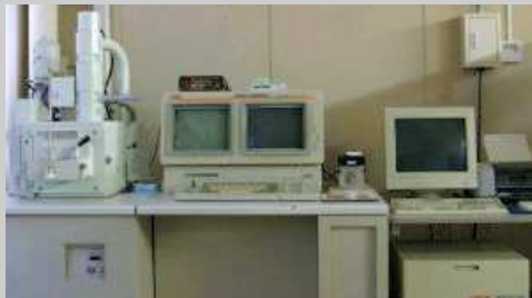
エネルギー分散型 X 線分析装置 日本電子(株) JED-2110/JSM-5800LV 型
