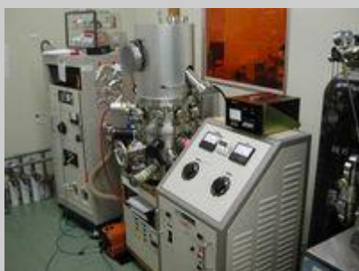
真空蒸着装置 アネルバ（株） VD-43N
