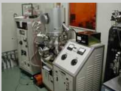
真空蒸着装置 アネルバ（株） VD-43N
